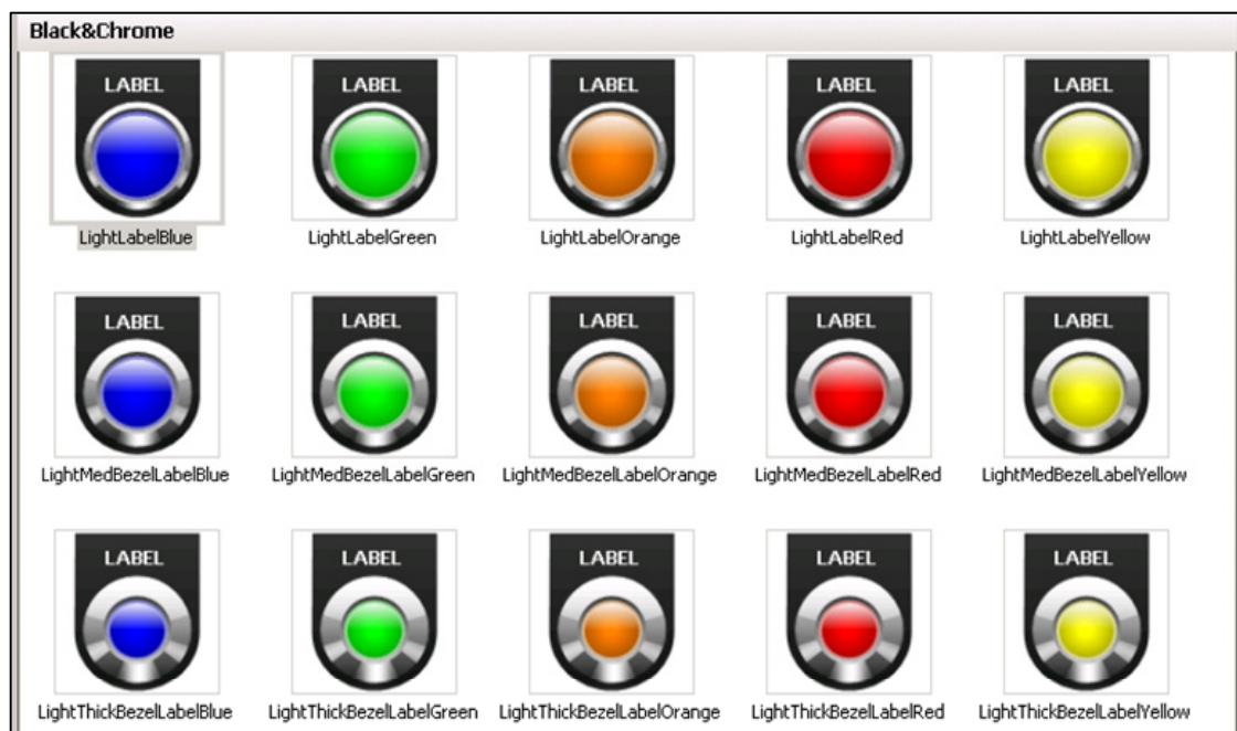
Obr. 4. Všechny tyto „staré“ symboly je nyní možno nahradit jediným „novým“ symbolem s volitelnou barvou a šírkou kovového okraje.
