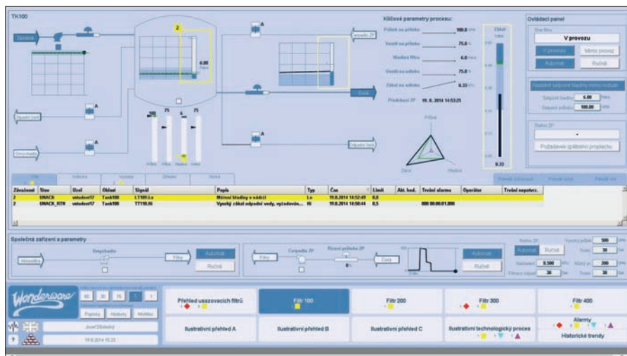
Obr. 3. Příklad obrazovky druhé úrovně, obvykle hlavní místo pro ovládání technologických procesů
