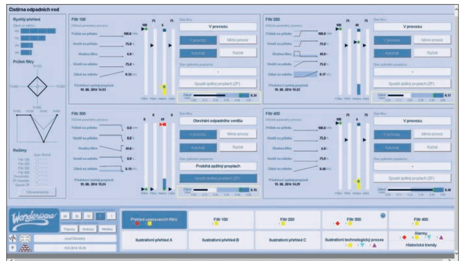
Obr. 2. Příklad obrazovky první úrovně s přehledovými informacemi (dashboard)
