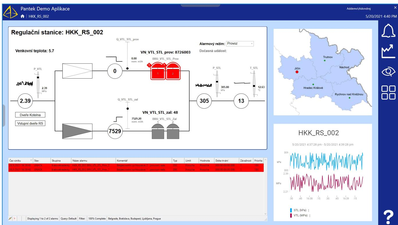
Ilustrativní ukázka objektu plynové regulační stanice se zobrazenými alarmy a trendy v aplikaci Geo SCADA
