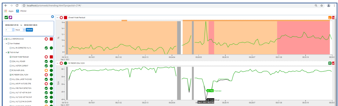
Analýza podílu odchylek jednotlivých proměnných na celkové residuální odchylce modelu
