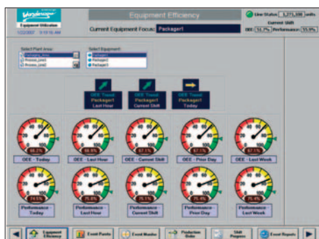
Obr. 2 Equipment Performance Module – názorné zobrazení aktuálních i historických hodnot o efektivitě využití výrobních zařízení (OEE)
